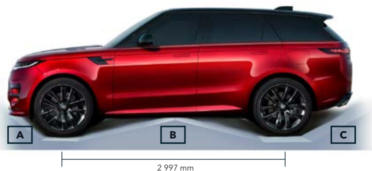
Rampas leņķis A tuvošanās leņķis 33,0° / 30,0° B bremzēšanas leņķis 26,09° C izlidošanas leņķis 30,0°
