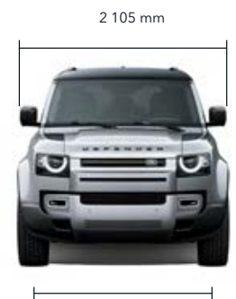
Pneimatiskā balstiekārta 1 706 mm Atsperu balstiekārta 1 704 mm
